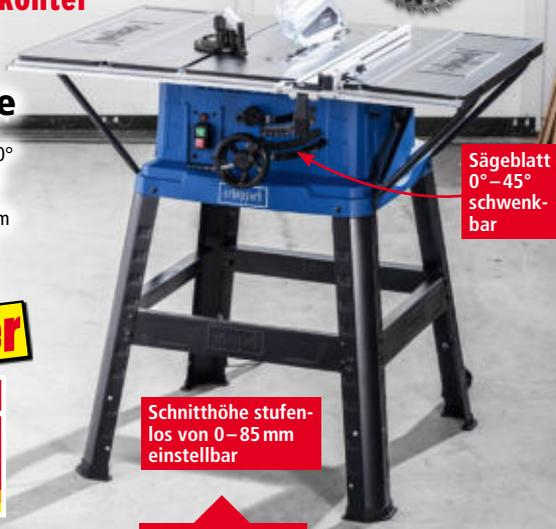
Sägeblatt 0°-45° schwenkbar
